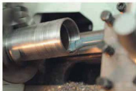
Beim Innendrehen kommt der mitgelieferte Drehmeißel an seine Grenzen
